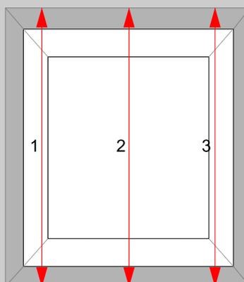
Messen Sie die Höhe an drei verschiedenen Stellen. Die kleinste Höhe ist die Bestellhöhe. Da die Aussenjalousie unter dem Fenstersturz montiert wird ist die Höhe der Fensteröffnung gleich der Gesamthöhe der Aussenjalousie
